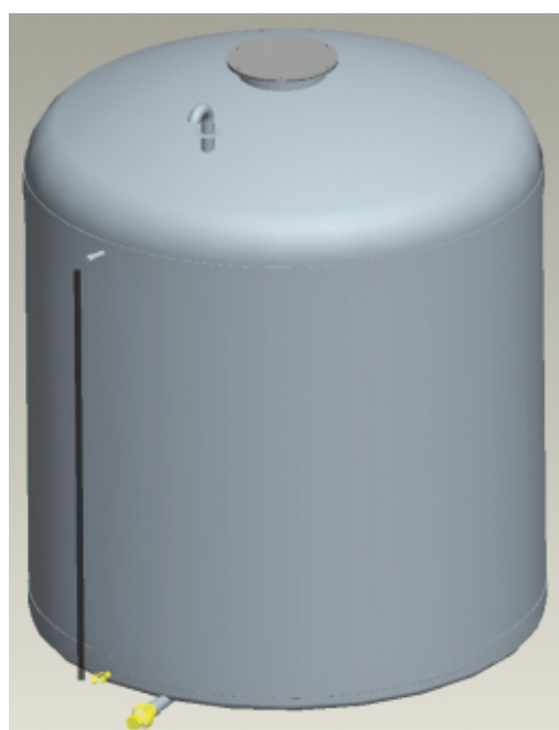
Vertikalna cisterna sa ravnim dnom
