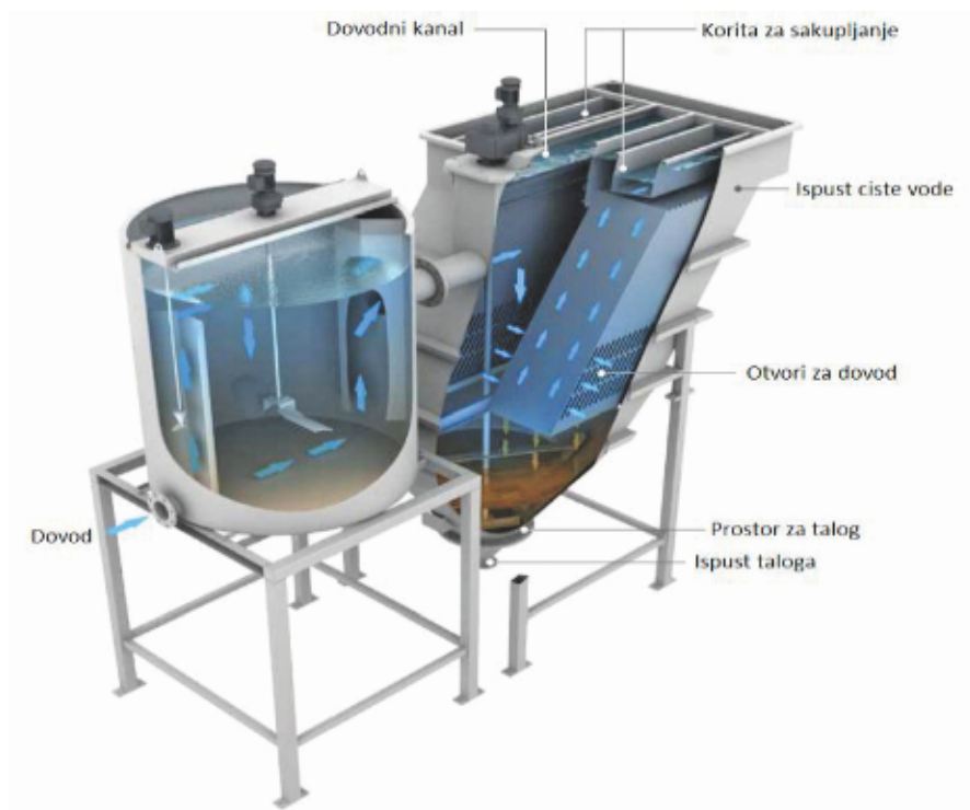
Kretanje vode kod lamelnog filtera sa flokulacionim tankom
